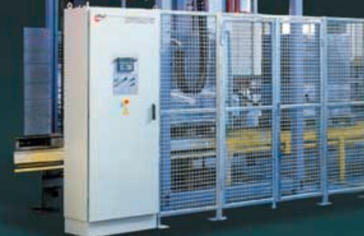
ОБС Ротоматик, полностью автоматизированная машина для упаковки товара на поддоне в стрейч пленку, предназначена для включения в производственные линии.
